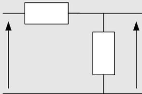
a) On a :  $X(s) = R.I(s) + Ls.I(s)$  ;  $Y(s) = Ls.I(s)$  ; d'où  $G(s) = \frac{Y(s)}{X(s)} = \frac{Ls}{R + Ls} = \frac{s}{s + R/L}$ .
